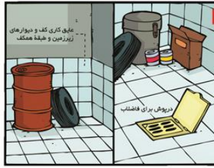
دیوار طبقات همکف و زیر زمین عایق شوند تا سیل نفوذ نکند. منبع آب آشامیدنی نباید با آب فاضلاب و سیل مخلوط شود.
